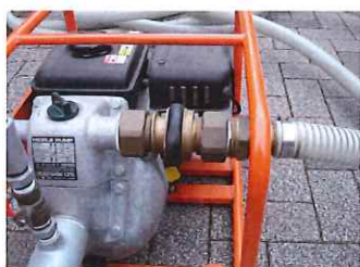
ポンプ吐出口への接続
