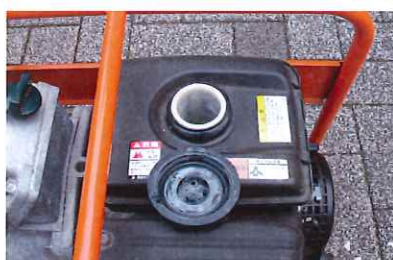
燃料タンクとタンクキャップ
