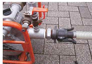
エンジンポンプ吸入口への接続
